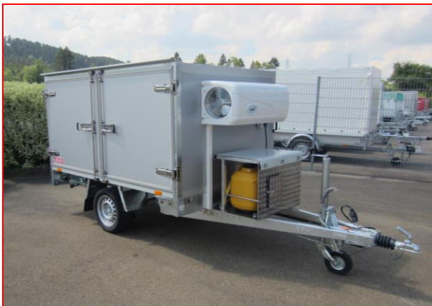
Fahrkühlung mittels Stromerzeuger
