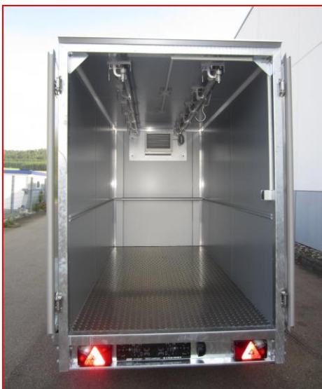
Rohrbahn für Fleischtransport
