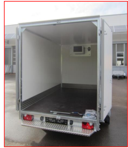
Innenverkleidung aus Aluriffelblech Aufstiegshilfe hinten (Treppenwanne)
