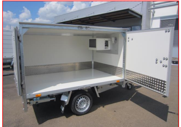
Seitliche Innenverkleidung aus Aluriffelblech, GFK Boden
